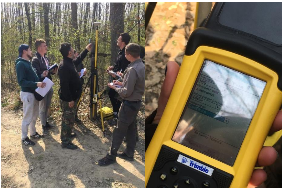
Foto 3 și 4. Utilizarea receptoarelor TRIMBLE R3 pentru poziționarea spațială a detaliilor (lucrare nr. 4)
