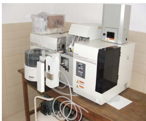
Spectofotometru cu absorbție atomică
