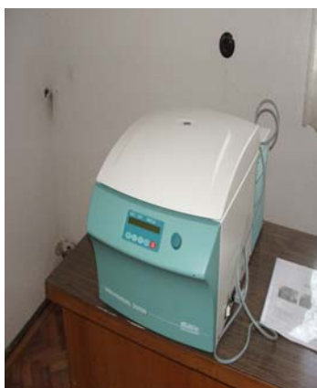
Centrifuga (15000 rotații/min 4°C)
