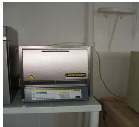
Cuptor de calcinare
