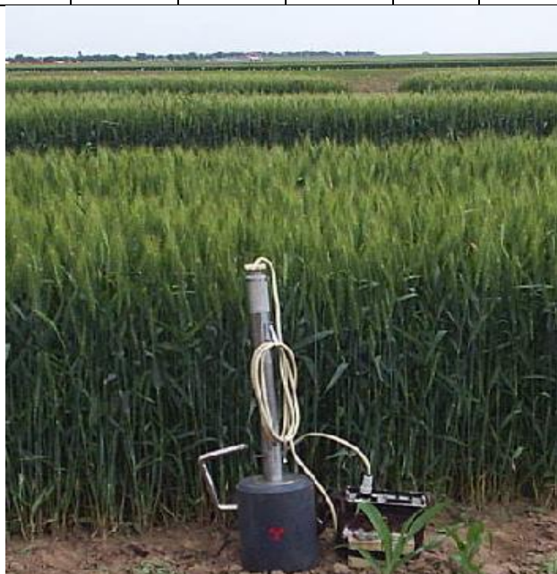
Foto 1. Sonda cu neutroni UVA 2 folosită pentru determinarea umidității solului
